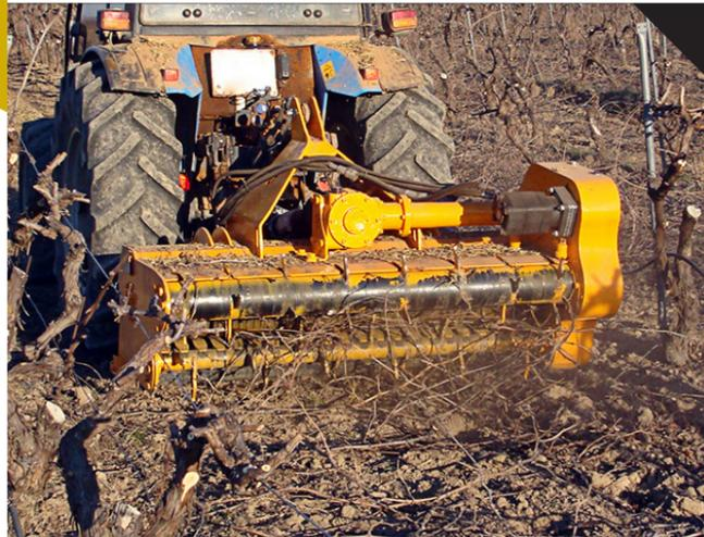
Holzhäcksler mit hydraulischem Pick up-System, für Traktoren mit 60 - 90 PS.
