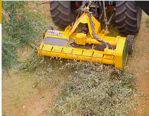
Mulcher mit doppeltem Hydraulik-Pick up-System, ideal für Schnittreste von Oliven-, Zitrusfrucht- und Hülsenfrucht-Bäumen mit einem Durchmesser von bis zu 60 mm.
