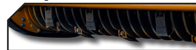
SERRAT-geschmiedete Forst-Hammerschlegel 360° einziehbar
