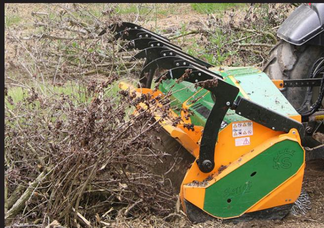
Forstmulcher für Traktoren mit 180 - 280 PS. Ausgestattet mit einziehbaren Hammerschlegeln, eignet es sich für den Einsatz in geschnittener Baumkronen, bei Waldlichtungen und für Gestrüpp und Unkraut.
