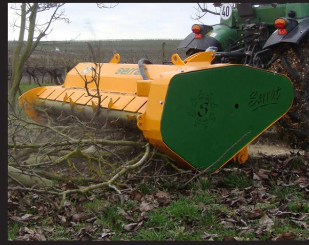
Mulcher mit bidirektionalem Hydraulik-Pick up-System, für Traktoren mit 100 - 160 PS.
