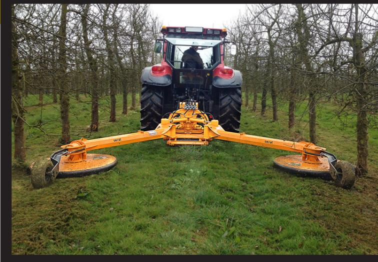
Doppelter Vertikal-Scheibenmäher mit mechanischem Seitenantrieb für die Pflege der Basis von Obstbäumen in Plantagen.
