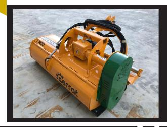
Universalmulcher für Traktoren mit Leistung von 60 bis 120 PS, der für die Pflege des Mulchmantels in der Landwirtschaft und für Holzäste bis zu 80 mm Durchmesser, entworfen wurde.
