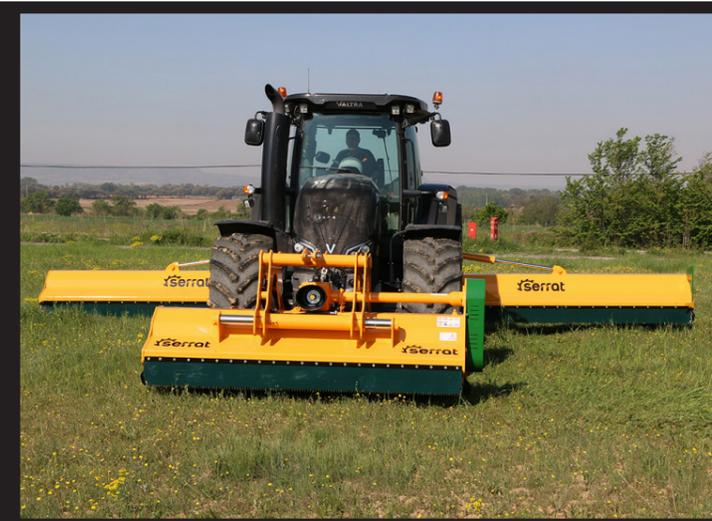
Großflächenmulcher für leistungsstarke Traktoren, der die Arbeitsbreite von 9,50 m erreichen kann.
