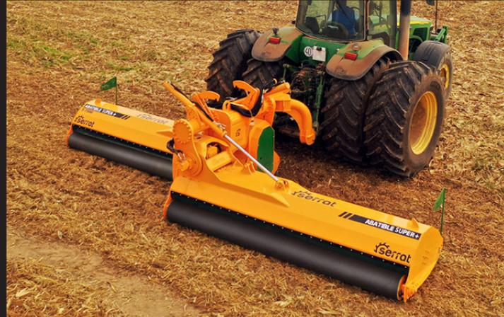
Derselbstklappbare Großflächenmulcher setzt sich aus 2 Standardmaschinen zusammen um in Kombination eine Arbeitsbreite von 7.30 m zu erreichen.
