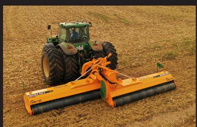
Der klappbare Großflächenmulcher setzt sich aus 2 Standartmaschinen zusammen um in Kombination auf einer Breite bis zu 6.30 m zu arbeiten.
