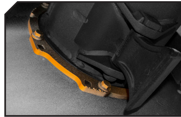
Rotor mit Wickelschutz-System
