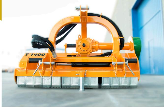
Universalmulcher für Traktoren mit Leistung von 30 bis 80 PS, der für die Pflege des Mulchmantels in der Landwirtschaft und für Holzäste bis zu 50 mm Durchmesser, entworfen wurde.
