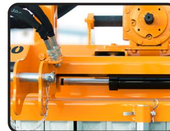
▶ Hydraulische Seitenverschiebung
