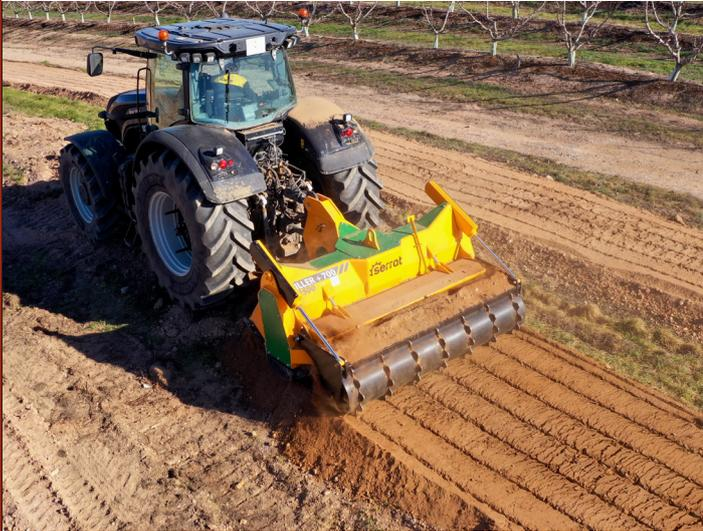
Bodenbearbeitungsmaschine bis zu einer Tiefe von 500 mm, geeignet für Traktoren mit 300 - 600 PS.
