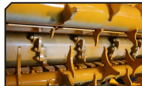
Rotor mit SPLINTER-Technologie
