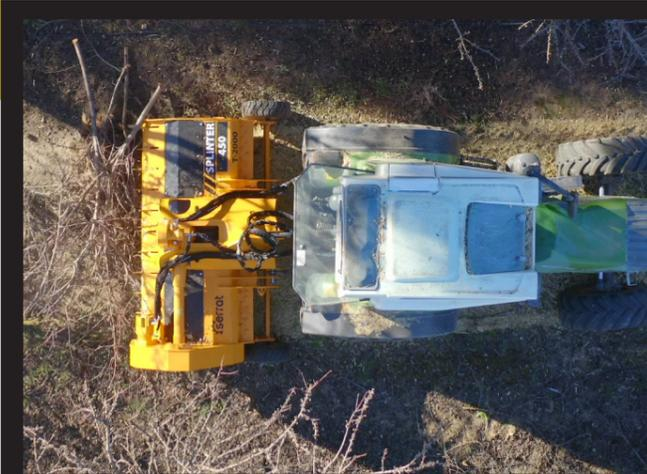
Mulcher mit doppeltem Hydraulik-Pick up-System, ideal für Schnittreste von Oliven-, Zitrusfrucht- und Hülsenfrucht-Bäumen mit einem Durchmesser von bis zu 100 mm.
