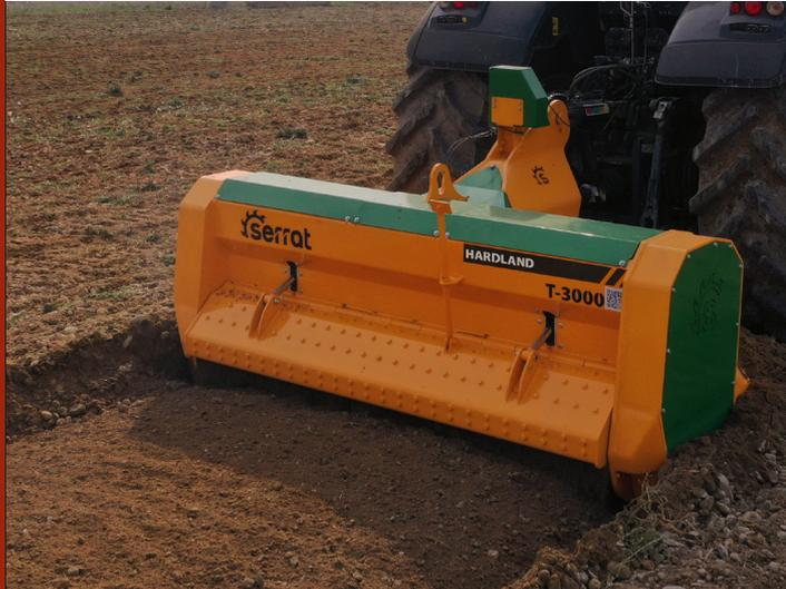
Bodenbearbeitungsmaschine bis zu einer Tiefe von 500 mm, geeignet für Traktoren mit 350 - 650 PS.
