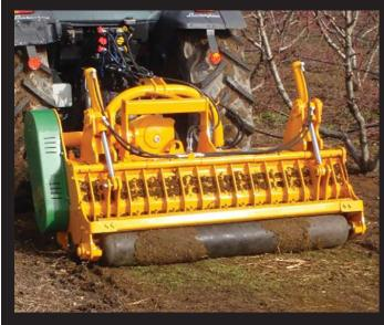
Mehrzweckmulcher zur Beseitigung von Zitrus -, Obst- und Olivenbaum-Schnittabfällen und für die Entsorgung von überstehendem Schnittgut.
