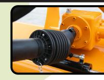
Getriebe mit Freilauf
