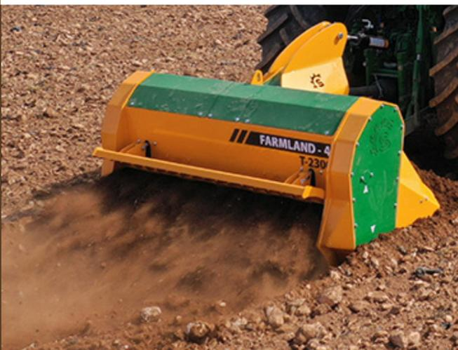
Bodenbearbeitungsmaschine bis zu einer Tiefe von 40 cm, geeignet für Traktoren mit 150 - 250 PS.
