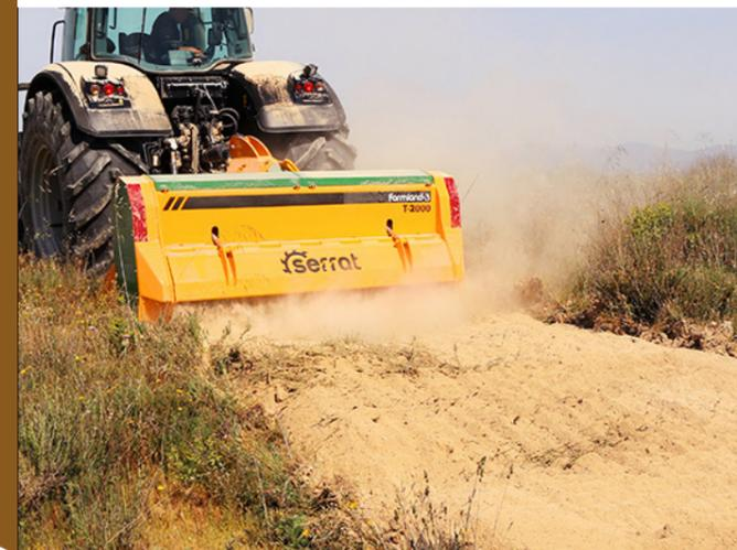
Bodenbearbeitungsmaschine bis zu einer Tiefe von 30 cm, geeignet für Traktoren mit 130 - 150 PS.
