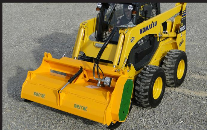
Mähkopf zum Ankoppeln an den Hubarm von Kompaktlader bis zu 5 t, angetrieben durch vorhandenen Hydraulikzirkuit.
