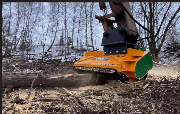
Mähkopf der sich für den Anbau an Bagger mit 15 - 30 t eignet.
