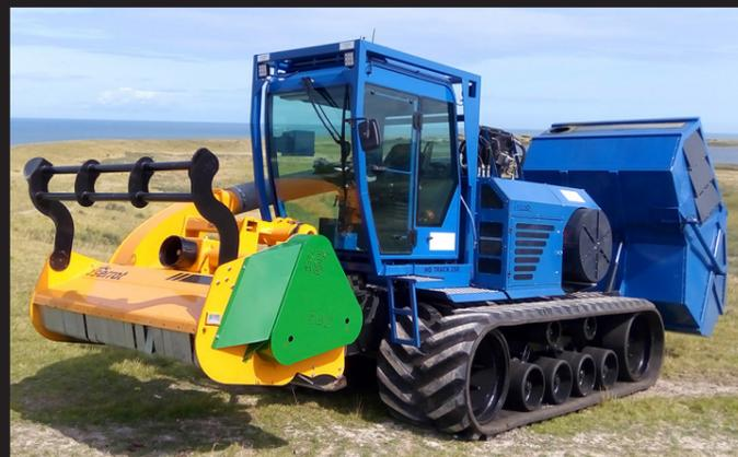
Der BIOSYLVA-Mulcher ist in der Lage, in einem einzigen Durchgang und mit der üblichen Geschwindigkeit, Gras und Gestrüpp bis zu 10 cm zu zerkleinern und in einen Container auszuwerfen, um diese aus dem Boden zu schaffen. Mit dieser Anwendungsart möchte SERRAT seinen Beitrag zur Pflege von Grünflächen und insbesondere von sumpfigen Gebieten, leisten. Das Schnittgut kann in einem Anhänger oder Container befördert werden und als Kompost weiterverwendet werden.
