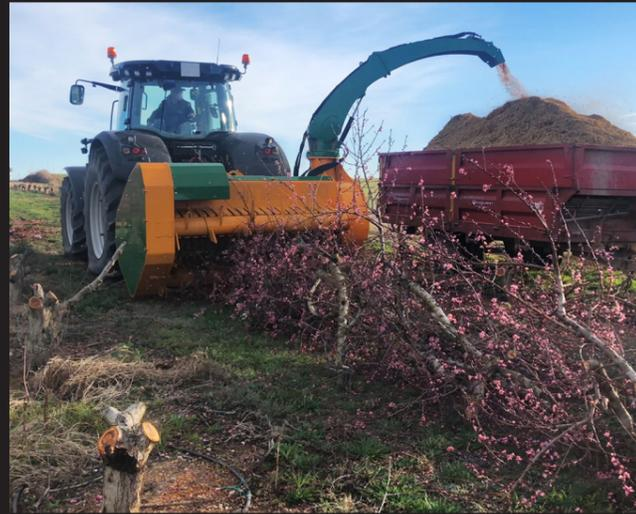
Mulcher für die Zerkümmelung und Rückgewinnung von Holz, zum Ankoppeln an Traktoren mit 300 - 500 PS. Das HIDRAHELP-System hilft beim Starten.
