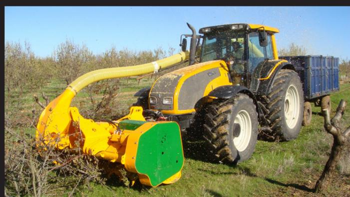
Mulcher für die Zerkhackselung und Rückgewinnung von Holz aus Obstbaumschnitt, Hülsenfrüchte und Waldreste usw.
