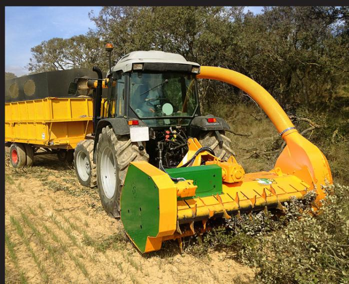
Häckselmaschine für die Rückgewinnung von Schnittreste aus Obstbäumen, Hülsenfruchte, Waldreste usw.
