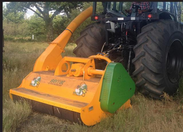
Der BIOGREEN-Mulcher ist in der Lage, in einem einzigen Durchgang und mit der üblichen Geschwindigkeit, Gras und Gestrüpp zu zerkleinern und in einen Container auszuwerfen, um diese aus dem Boden zu schaffen.
