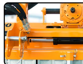
▶ Hydraulische Seitenverschiebung
