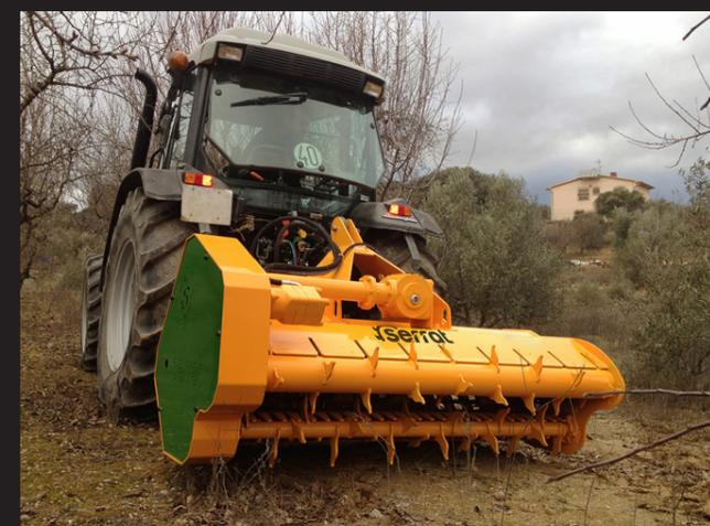
Mulcher mit bidirektionalem Hydraulik-Pick up-System zum Zerkleinern von Schnittresten aus Oliven-, Zitrus- und Hülsenfrucht-Bäumen bis 6 - 8 cm Durchmesser.
