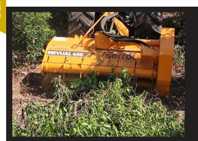
Mulcher mit doppeltem Hydraulik-Pick up-System, ideal für Oliven-, Zitrusund Hülsenfrucht-Bäumen mit einem Durchmesser bis zu 5 - 7 cm Durchmesser.
