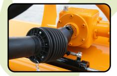
► Getriebe mit Freilauf
