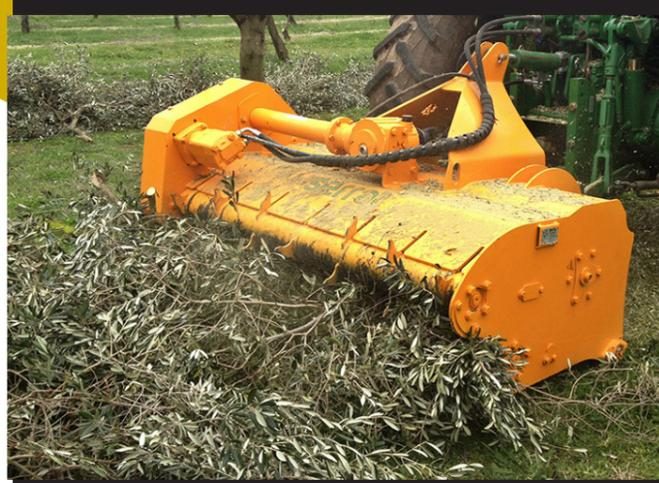
Mulcher mit bidirektionalem Hydraulik-Pick up-System, für Traktoren mit 60 - 120 PS. Ideal für die Anwendung in Weinbergen und Plantagen von Oliven-, Mandel- und Zitrusbäumen.
