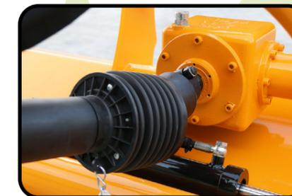
▶ Getriebe mit Freilauf
