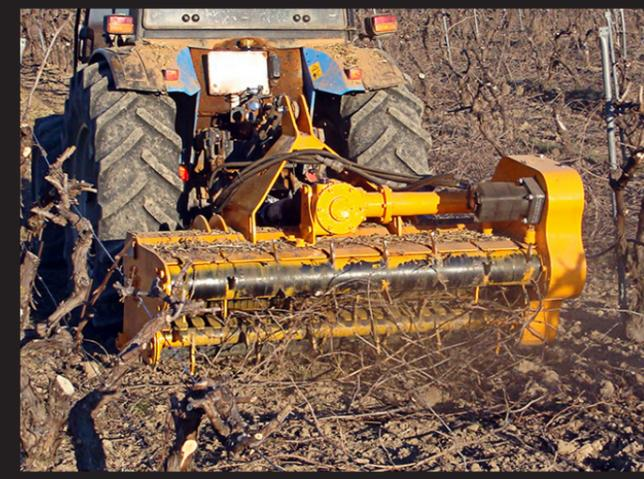
Mulcher mit bidirektionalem Hydraulik-Pick up-System, für Traktoren mit 60 - 90 PS. Ideal für die Anwendung in Weinberge und Plantagen von Oliven-, Mandeln- und Zitrusbäumen.
