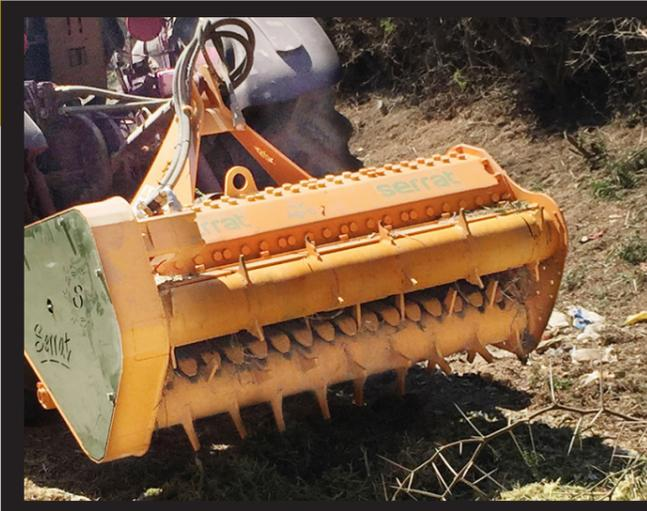
Mulcher mit bidirektionalem Hydraulik-Pick up-System, für Traktoren mit 50 - 70 PS. Ideal für die Anwendung in Weinberge und Plantagen von Oliven-, Mandeln- und Zitrusbäumen.
