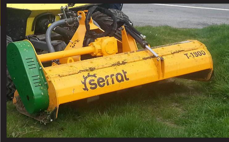
Universalmulcher für Traktoren mit Leistung von 70 - 80 PS, der für die Pflege des Mulchmantels in der Landwirtschaft und für Holzäste bis zu 50 mm Durchmesser, entworfen wurde.
