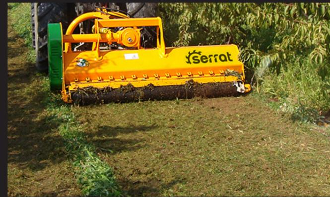
Schlegelmulcher mit Hammerschlegel, der für die Beseitigung von Schnittabfällen bis zu 8 cm und für die Pflege des Mulchmantels, geeignet ist. Ideal für die Regenerierung von Grasland und Weiden.
