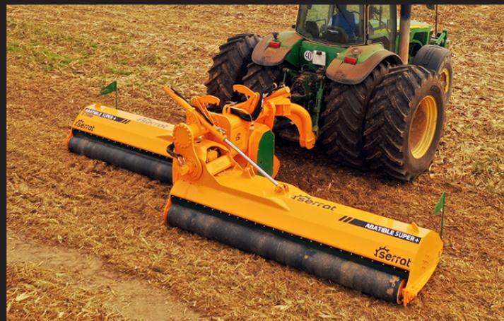
Der klappbare Großflächenmulcher setzt sich aus 2 Standardmaschinen zusammen um in Kombination auf eine Breite bis zu 7.30 m, zu bearbeiten.
