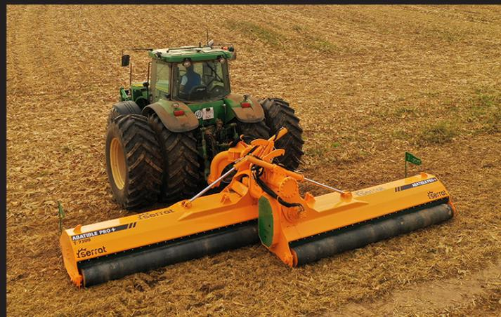
Der klappbare Großflächenmulcher setzt sich aus 2 Standardmaschinen zusammen um in Kombination auf einer Breite bis zu 6.30 m, zu arbeiten.
