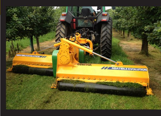
Es ermöglicht in einem einzigen Durchgang, das Bearbeiten der beiden Reihen von Obstbäumen- und Olivenbaumplantagen, zirkulieren den Traktor durch die Mitte der Straße, sowie das Mähen von Gras in Grünanlagen, Flughäfen, etc.
